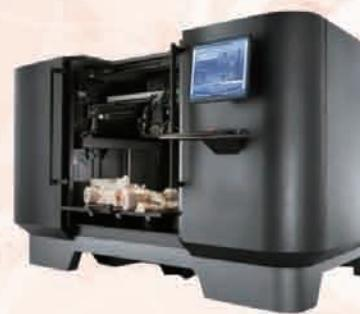
3D打印机，即快速成形技术的一种机器，它是一种数字模型文件为基础，运用粉末状金属或塑料等可粘合材料，通过逐层打印的方式来构造物体的技术。过去其常在模具制造、工业设计等领域被用于制造模型，现正逐渐用于一些产品的直接制造，意味着这项技术正在普及。
